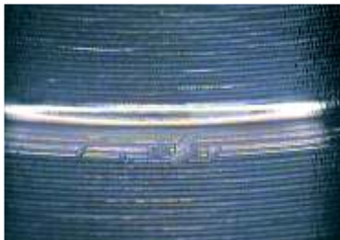
Große Ausbrüche bei den Schnittkanten bei herkömmlich hergestelltem Material
